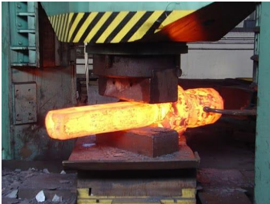
Figura 2. Ejemplo de proceso de formado - forjado aplicado a metales con resistencia a altas temperaturas y fuerza de presión. [4]
