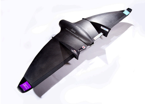
Fig. 4 Primer planeador recubierto de grafeno
